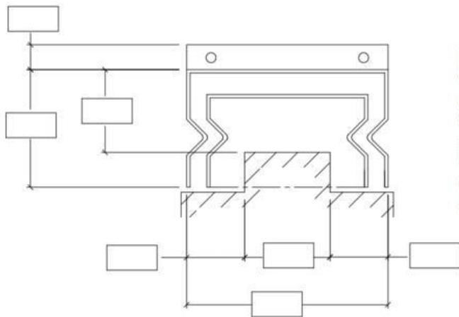
Внимание! 90% защит в исполнении типа "Е" установлены на единственной направляющей. Изгибы с V-образным ограничением позволяют заметно сократить боковой габарит и получить ровные элементы в нижней части. Исполнение типа "Е" не рекомендуется на копусах больших размеров или на работающих с большой скоростью корпусах.
